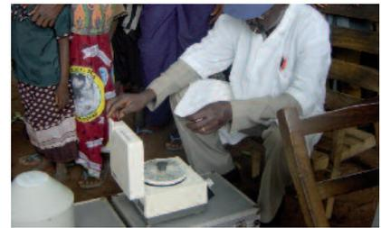
Figure 10 – Réalisation de la centrifugation en tubes capillaires.
